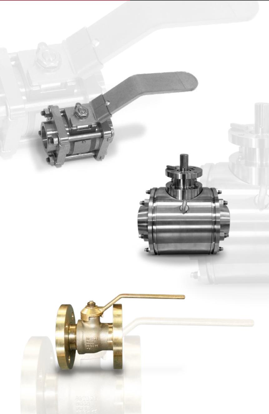
Le Robinet à Tournant Sphérique est utilisé pour le sectionnement de fluide. Le RTS permet un temps de manœuvre rapide (technologie 1/4 de Tour), un faible encombrement, une très bonne étanchéité (interne et externe) et une très faible perte de charge (équivalent à un tube du même diamètre).
